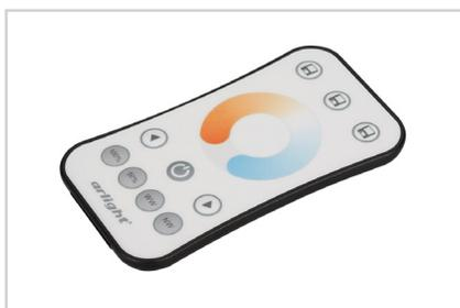
Кнопочный радиопульт с сенсорным кольцом (2.4 ГГц) белого цвета для управления MIX (CCT) источником света. 1 зона управления, выбор температуры свечения с помощью сенсорного кольца. Питание DC 3 В (CR2032). Размеры 107×58.5×9 мм. Изготовлен из пластика с покрытием, защищающим от загрязнения. Управляет контроллерами и панелями серии SMART (поставляются отдельно). Настенные держатели приобретаются отдельно (см. аксессуары).
