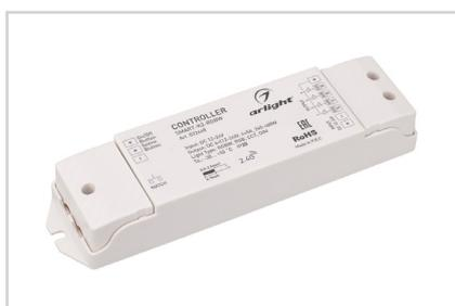
Контроллер для светодиодной RGBW-ленты (ШИМ). Питание/рабочее напряжение DC 12–24 В, максимальный ток 5 А на канал, 4 канала, максимальная мощность 240–480 Вт. Винтовые клеммы. Корпус PVC. Размеры 175×45×27 мм. Управляется пультами и панелями серии SMART (поставляются отдельно).
