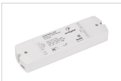
Многофункциональный 5-канальный контроллер для светодиодной RGB и MIX-лент (ШИМ) предназначен для смешивания RGB и белого цветов. Питание/рабочее напряжение DC 12–24 В, максимальный ток 4 А на канал, 5 каналов, максимальная мощность 240–480 Вт. Винтовые клеммы. Корпус PVC. Размеры 170×50×23 мм. Управляется пультами и панелями серии SMART (поставляются отдельно).
