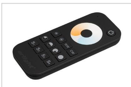
Кнопочный радиопульт с сенсорным кольцом (2.4 ГГц) черного цвета для управления MIX-источником света. 1 зона управления, 4 слота памяти пользовательских настроек, управление яркостью с помощью сенсорного кольца. Питание DC 3 В (AAA\*2). Размеры 122×53×18 мм. Изготовлен из пластика с покрытием Soft Touch. Управляет контроллерами и панелями серии SMART (поставляются отдельно). Настенные держатели приобретаются отдельно (см. аксессуары).
