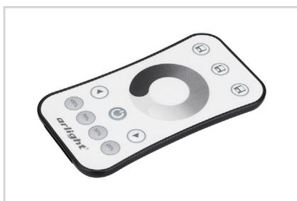
Кнопочный радиопульт с сенсорным кольцом (2.4 ГГц) белого цвета для управления одноцветным (DIM) источником света. 1 зона управления, управление яркостью с помощью сенсорного кольца. Питание DC 3 В (CR2032). Размеры 107×58.5×9 мм. Изготовлен из пластика с покрытием, защищающим от загрязнения. Управляет контроллерами и панелями серии SMART (поставляются отдельно). Настенные держатели приобретаются отдельно (см. аксессуары).
