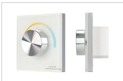
Встраиваемая стеклянная роторная панель (2.4 ГГц) белого цвета для управления MIX (CCT) источниками света (ШИМ). Управление цветовой температурой с помощью роторного вращателя. Работает в режиме Master/Slave и может выполнять функцию независимого контроллера. Питание/рабочее напряжение DC 12–24 В, максимальный ток 5 А на канал, 2 параллельных канала, максимальная суммарная мощность 120–240 Вт. Размеры 86×86×50 мм. Панель совместима с контроллерами серии SMART.
