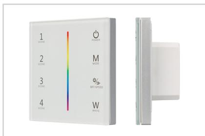
Встраиваемая стеклянная сенсорная панель (2.4 ГГц) белого цвета для управления светодиодными RGBW-источниками света (ШИМ). Управление цветом с помощью сенсорной полосы. Работает в режиме Master/Slave и может выполнять функцию независимого контроллера. Питание/рабочее напряжение DC 12–24 В, максимальный ток 3 А на канал, 4 канала, максимальная мощность 144–288 Вт. Размеры 86×86×37 мм. Панель совместима с контроллерами серии SMART.
