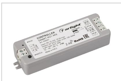
Контроллер для светодиодной MIX-ленты (ШИМ). Питание/рабочее напряжение DC 12–24 В, максимальный ток 5 А на канал, 2 канала, максимальная мощность 120–240 Вт. Винтовые клеммы. Корпус PVC. Размеры 97×33×18 мм. Управляется пультами и панелями серии SMART (поставляются отдельно).
