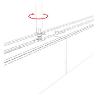
1. Просверлите отверстие и зафиксируйте соединитель SL-01-1000 на профиле.
