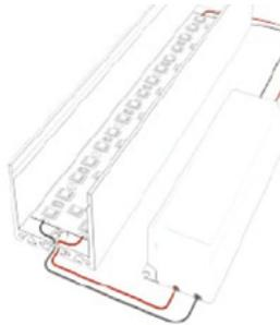
При использовании более 2,5 м светодиодной ленты, подключайте питание с двух сторон.
