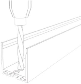
1. Просверлите отверстия для крепления профиля и продевания кабеля.
