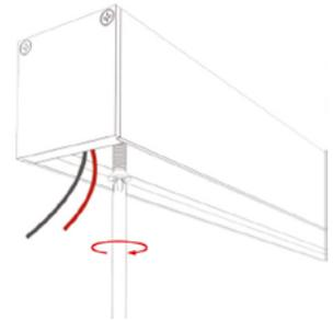
3. Проведите кабель питания через отверстие. Закрепите профиль на поверхности.
