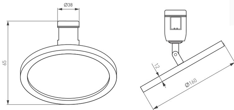
Рис. 1. Чертеж и габаритные размеры
