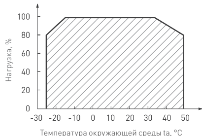
Рис. 2. Максимальная допустимая нагрузка, % от мощности источника
