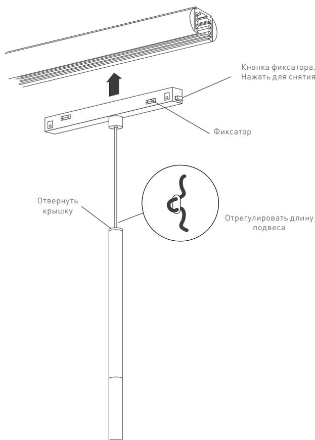
Рис. 2. Установка светильника
