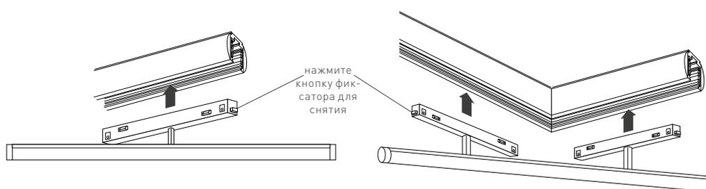
Рис. 2. Установка светильника
