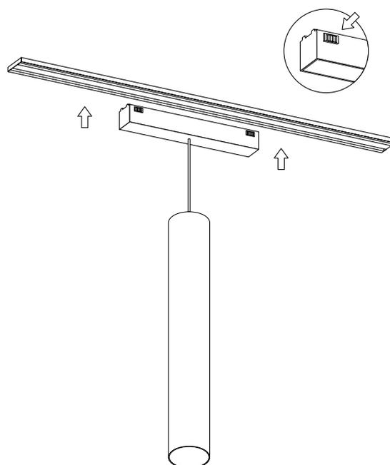
Рис. 2. Установка светильника
