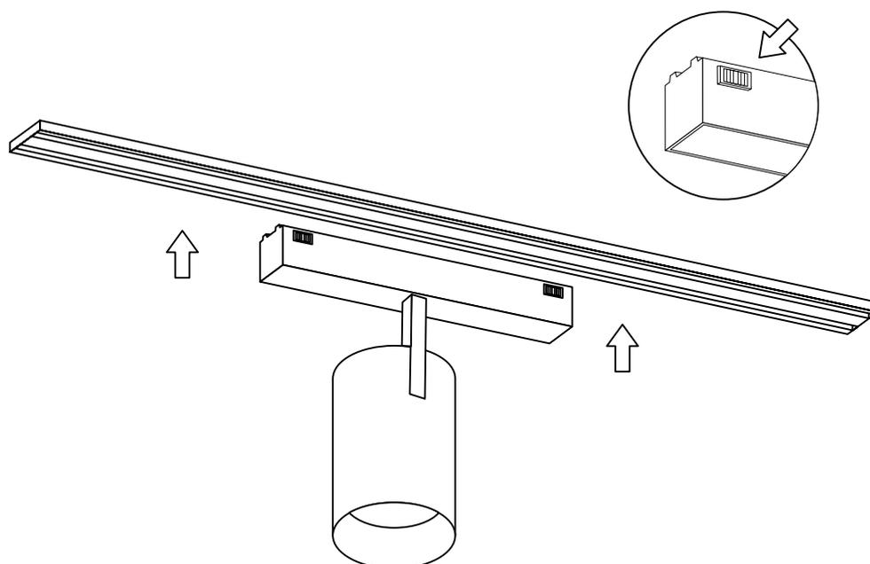
Рис. 2. Установка светильника
