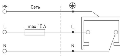
Рис. 4. Схема подключения
